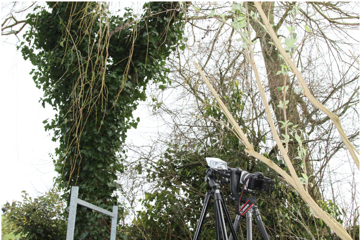
Pilot-opstelling voor de registratie van het gebruik van een bekende slaappleats door de Huismus, bestaande uit een hoge resolutie thermische filmcamera verbonden aan een laptop, en een Canon EOS 5D camera met film-opties.
